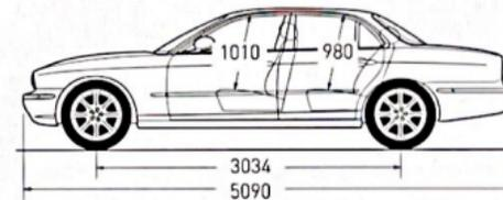
Abmessungen in mm. Hinweis: Die Maßangaben gelten für ein normales Fahrzeug mit voller Zuladung, können im Einzelfall aber aufgrund von Konstruktions- und Fertigungstoleranzen geringfügig abweichen. Wo immer dies möglich war, wurden die Normalmaße angegeben. Maßänderungen in Verbindung mit dem Einbau von Sonderausstattungen sind beim Jaguar Vertragspartner zu erfragen.
